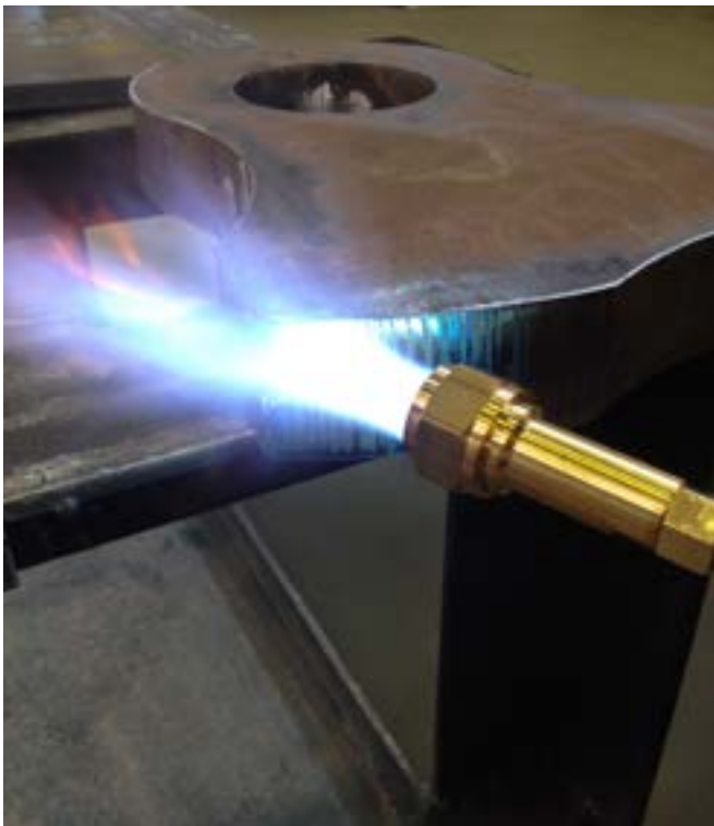
Hình 9: Gia nhiệt sau theo cách thủ công.
