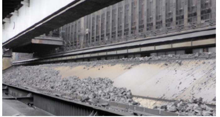
Şekil 4. Toolox® 33'ten yapılmış soğutma ızgarası
