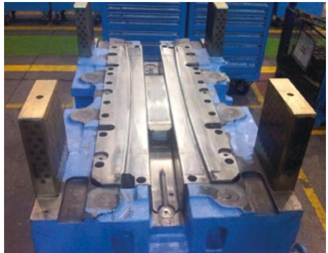
Resim 2: Parçalı olmayan (yekpare) sıvama kalıbı.
