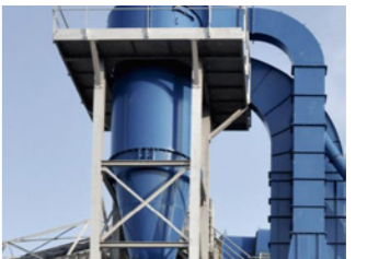
ข้อต่อ 90 องศา ข้อต่อ 90 องศา (elbow pipes) เมื่อทำจาก Hardox® HiAce หรือ Hardox® 500 Tuf จะทนทานต่อการสึกหรอจากการเสียดสีได้ดีมาก และเพิ่มอายุการใช้งานได้อีกยาวนานขึ้นพร้อมลดต้นทุนตลอดอายุใช้งานลง
