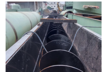
สายพานลำเลียงเมล็ดและเส้นใย สายพานลำเลียงเมล็ดและเส้นใย (cake breaker conveyors) ต้องทนต่อการสึกหรอจากการกัดกร่อนจากเมล็ดและเส้นใย เมื่อใช้เหล็ก Hardox® HiAce สามารถลดความหนาของใบเคลือบและ cover liner ลงได้ ทำให้น้ำหนักเบาและแข็งแรงขึ้น ส่งผลให้อายุการใช้งานเพิ่มขึ้นอย่างมากและลดการใช้พลังงานไฟฟ้าลง
