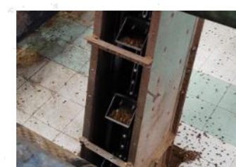
กระพ้อลำเลียง กระพ้อลำเลียง (bucket elevators) เมื่อผลิตด้วย Hardox® HiAce จะได้อายุการใช้งานที่ยาวนานขึ้นและประหยัดพลังงานยิ่งขึ้น
