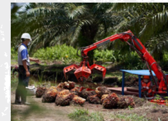
ชุดคืบปาล์ม ชุดคืบปาล์ม (fruit grabbers) ที่ผลิตโดยใช้ Hardox® HiAce จะมีขนาดที่บางลงและใช้งานได้นานกว่าชุดคืบที่ผลิตจากเหล็กเหนียว
