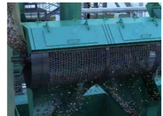
สายพานลำเลียงเมล็ดและเส้นใย สายพานลำเลียงเมล็ดและเส้นใย (cake breaker conveyors) ต้องทนต่อการสึกหรอจากการกัดกร่อนจากเมล็ดและเส้นใย เมื่อใช้เหล็ก Hardox® HiAce สามารถลดความหนาของใบเคลือบและ cover liner ลงได้ ทำให้น้ำหนักเบาและแข็งแรงขึ้น ส่งผลให้อายุการใช้งานเพิ่มขึ้นอย่างมากและลดการใช้พลังงานไฟฟ้าลง
