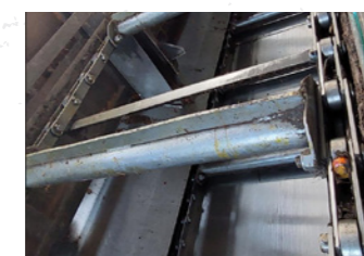
CHAIN CONVEYOR SYSTEMS พื้นสายพาน โซ่ และแผ่นรองต้องรับมือกับการสึกหรอจากการกัดกร่อน และจะมีความทนทานมากขึ้นเมื่อผลิตจาก Hardox® HiAce
