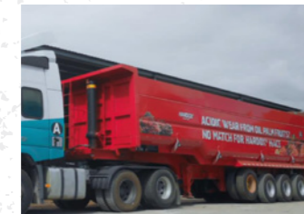
รถบรรทุกขนปาล์ม แต่เดิมนั้น กระบะดับพื้ทำจากเหล็กเหนียวที่เชื่อมเป็นทรงเหลี่ยม ดีไซน์ที่ทันสมัยกว่าซึ่งผลิตจาก Hardox® HiAce ให้อายุการใช้งานยาวนานกว่า มีน้ำหนักเบากว่า ช่วยให้เพิ่มน้ำหนักบรรทุกได้มากขึ้น
