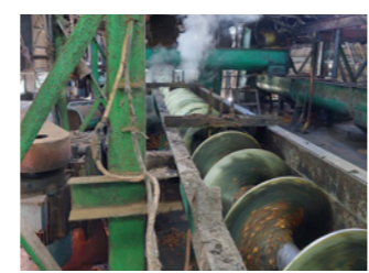
สกรูลำเลียง สกรูลำเลียง (screw conveyors) มีประสิทธิภาพมากขึ้นและมีอายุการใช้งานยาวนานกว่าเดิมเมื่อใช้แผ่นเหล็ก Hardox® HiAce ที่บางลงเมื่อเทียบกับที่ใช้เหล็กเหนียว
