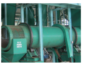
เครื่องเหยียงแยกผลปาล์ม เครื่องเหยียงแยกผลปาล์ม (nut polishing drums) เมื่อผลิตด้วย Hardox® HiAce ให้อายุการใช้งานที่ยาวนานขึ้นมากโดยมีต้นทุนตลอดอายุใช้งานต่ำลง หากใช้แผ่นเหล็กที่บางลงมาผลิตเครื่องเหยียง เครื่องก็จะเบาและลดพลังงานไฟฟ้าที่ต้องใช้ในการทำงานลงด้วย
