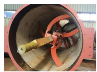
สกรูลำเลียง สกรูลำเลียง (screw conveyors) มีประสิทธิภาพมากขึ้นและมีอายุการใช้งานยาวนานกว่าเดิมเมื่อใช้แผ่นเหล็ก Hardox® HiAce ที่บางลงเมื่อเทียบกับที่ใช้เหล็กเหนียว
