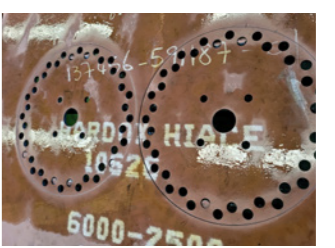
เครื่องเหยียงแยกผลปาล์ม เครื่องเหยียงแยกผลปาล์ม (nut polishing drums) เมื่อผลิตด้วย Hardox® HiAce ให้อายุการใช้งานที่ยาวนานขึ้นมากโดยมีต้นทุนตลอดอายุใช้งานต่ำลง หากใช้แผ่นเหล็กที่บางลงมาผลิตเครื่องเหยียง เครื่องก็จะเบาและลดพลังงานไฟฟ้าที่ต้องใช้ในการทำงานลงด้วย
