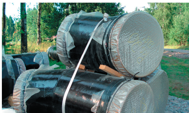
Figur 2. Rörändarna är skyddade med plastfilm
