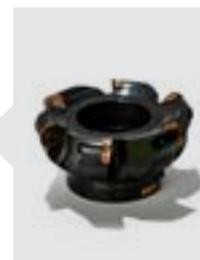
\*При фрезеровании сталь Hardox® HiAce показала себя чрезвычайно абразивной. Рекомендуется использовать сменную пластину высокой твёрдости (P10-P20). Пластина должна иметь простую геометрию (L).
