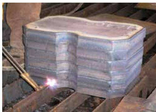
**РИСУНОК 4.** Последующая термообработка вручную
