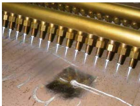
**РИСУНОК 3.** Горелка для предварительного нагрева
