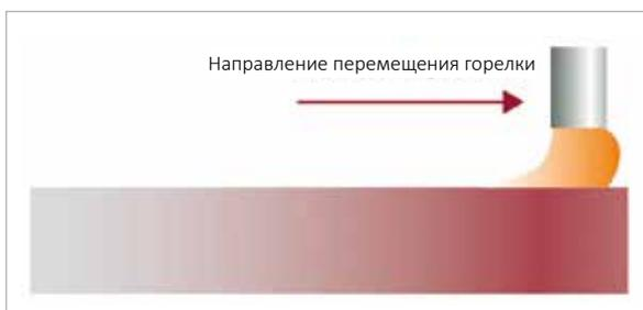
**РИСУНОК 6.** Цвет кромки в процессе последующей термообработки горелкой.
