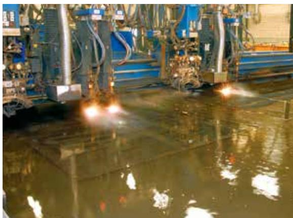
**РИСУНОК 12.** Погружная резка
