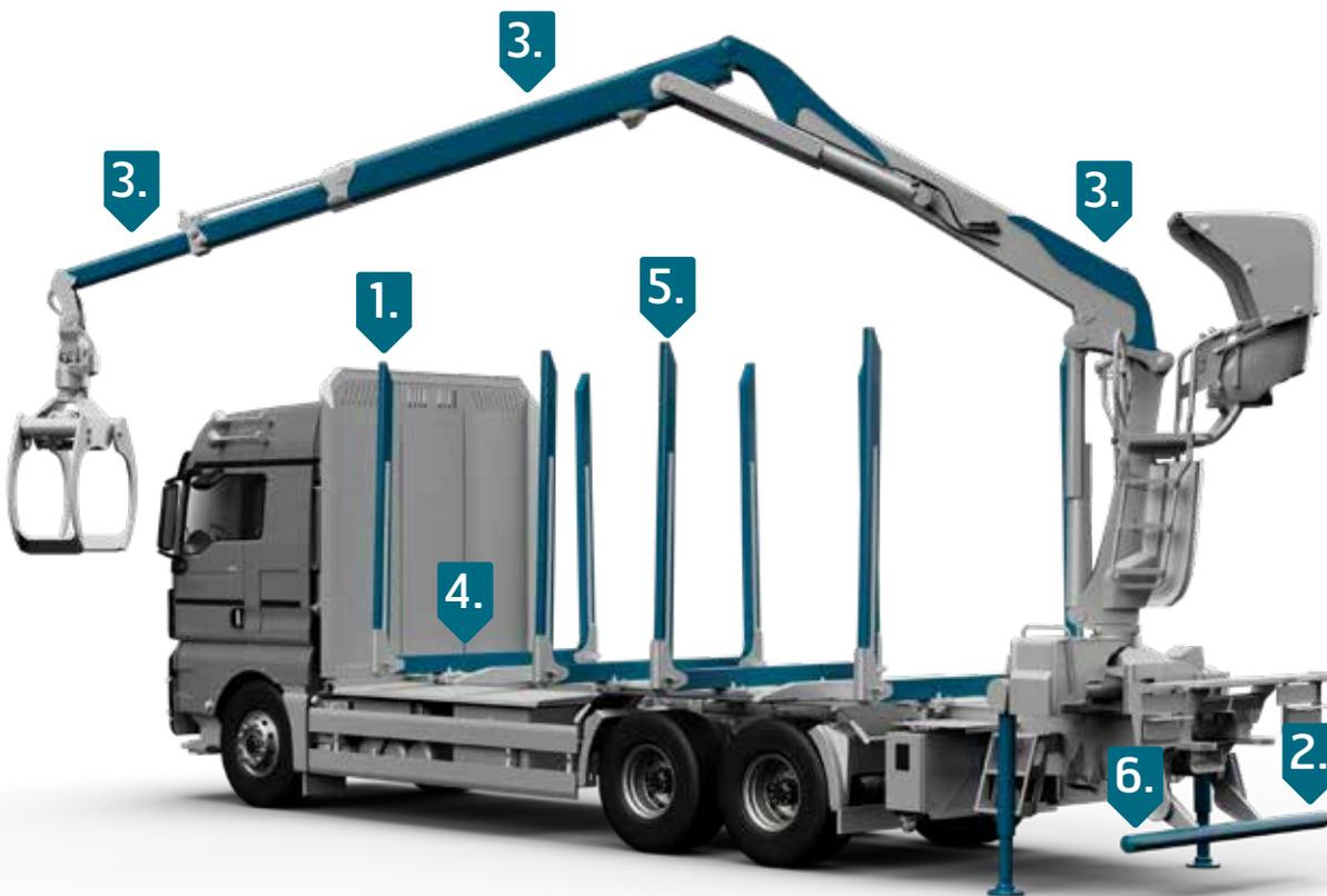
**1.** Tubos de aço de alta resistência Tubo Strenx® 700MLH, Tubo Strenx® 900MH
