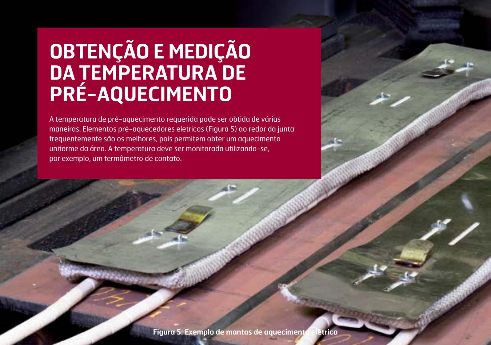
Figura 5: Exemplo de mantas de aquecimento elétrico
