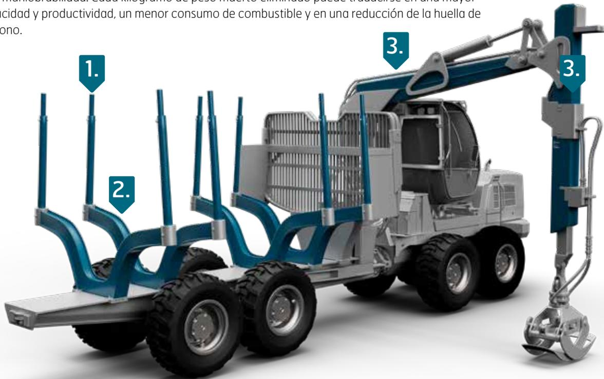
**1.** Tubos de acero de alta resistencia Strenx® Tube 700MLH, Strenx® Tube 900MH y Strenx® Tube 960QLH
