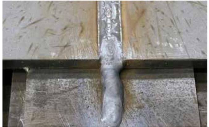
**FIGURA 25** Dirección adecuada de las marcas del disco de desbaste, orientadas de forma longitudinal a la tensión.
