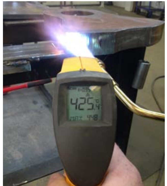
그림 10: 후열 처리 도중 온도 측정.
