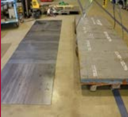
1. 床に熱保護材を置く (床が熱に弱い場合)
