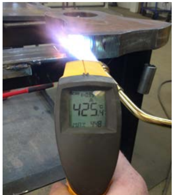
図10:後熱処理中の温度測定。
