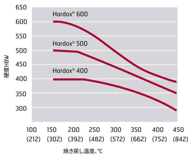
図11:表面硬度と焼き戻し温度の比較。
