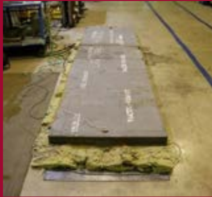
5. プレートの上に置き、時間の経過とともに温度を記録するサーマルカップルを設置する
