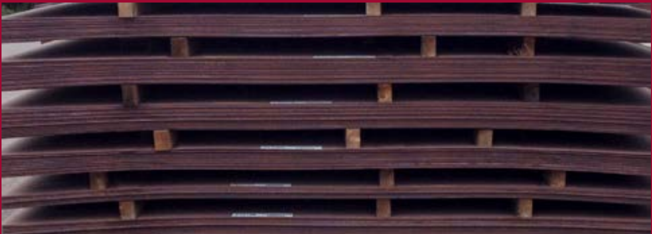
13b 不適切に積み重ねられた鋼板。
