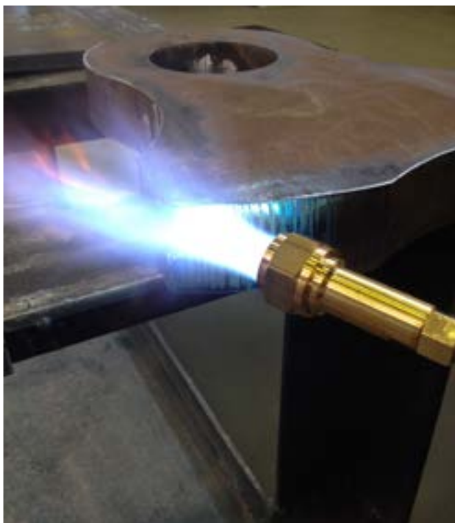
図9:手動による後熱処理。
