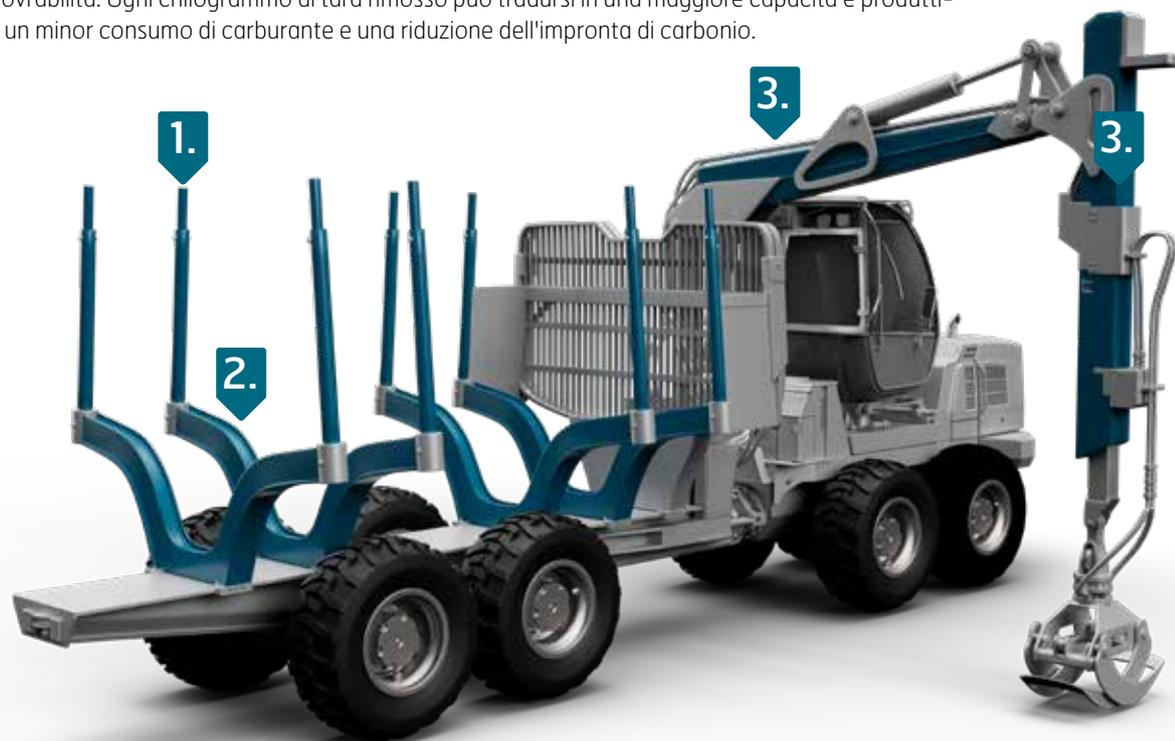
**1.** Tubi in acciaio altoresistenziale Strenx® Tube 700MLH, Strenx® Tube 900MH, Strenx® Tube 960QLH
