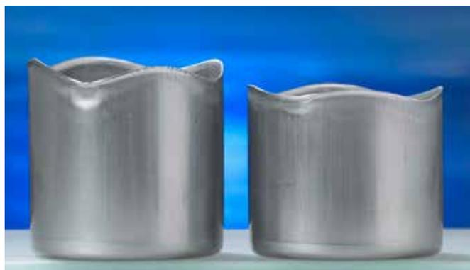
**Figura 35.** Impatto della viscosità del lubrificante sul processo di imbottitura. Altezza massima della coppa con lubrificanti a viscosità 500 cSt (a sinistra) e 40 cSt (a destra).
