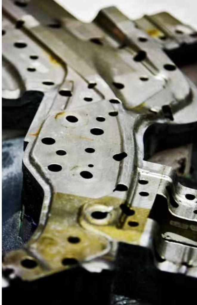
industriali. Gli utensili di formatura (con finitura superficiale di  $R_a \leq 0,2 \mu\text{m}$ ) realizzati in Uddeholm Vancron SuperClean, lavorano molto meglio degli utensili rivestiti.
