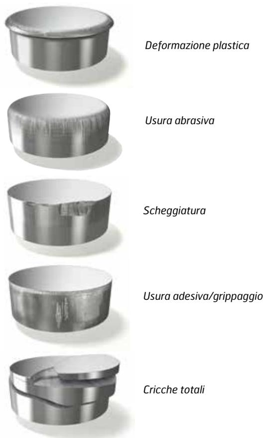
La deformazione plastica, la presenza di bava sui bordi e la scheggiatura causano spesso gravi danni e fermi di produzione molto dispendiosi e devono essere evitati, se possibile. L'usura e il grippaggio sono più prevedibili e possono essere gestiti, in una certa misura, dai programmi di manutenzione degli utensili. Una conseguenza di ciò è che può valere la pena di consentire una maggiore usura dell'utensile piuttosto che incorrere in situazioni di scheggiatura e fessurazione.
