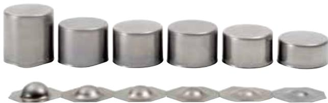
Figura 5. Dimensioni massime raggiunte per imbutitura profonda (coppa) e formatura per stiramento (cupola). Tipi di acciaio (da sinistra a destra): CR5, Docol 600DP, Docol 800DP, Docol 1000DP, Docol 1200M e Docol 1400M.
