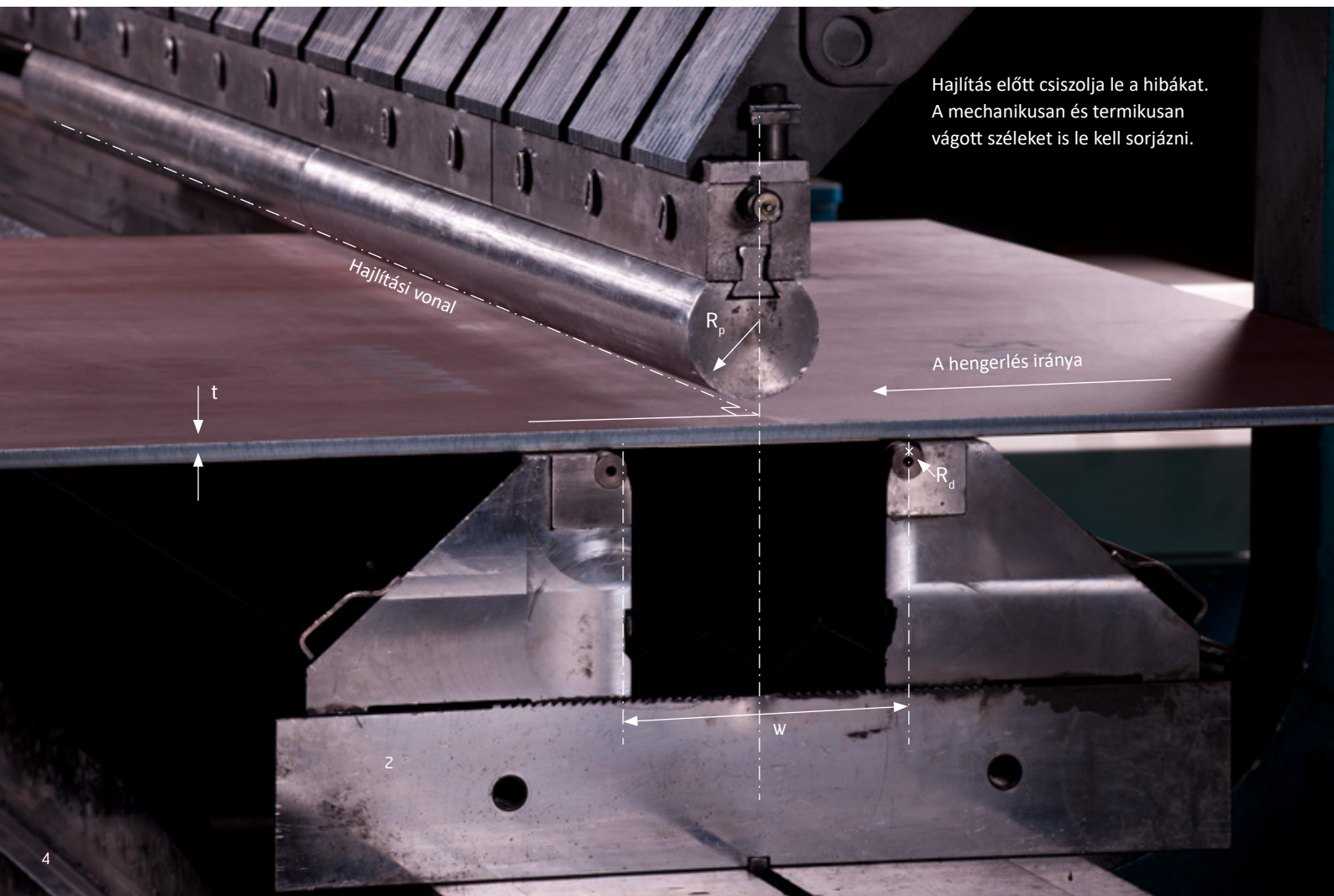
1. ÁBRA Hajlítás keresztirányban a hengerlés irányához képest
