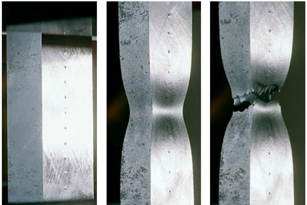
Test de traction  $R_m$  (N/mm<sup>2</sup>)
