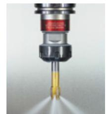
Mandrin synchro souple pour machine CNC.
