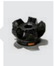
\*Hardox® HiAce s'est montré très abrasif au fraisage. Une plaquette de dureté élevée (plage P10-P20) est recommandée. La plaquette doit avoir une géométrie de coupe légère (L).
