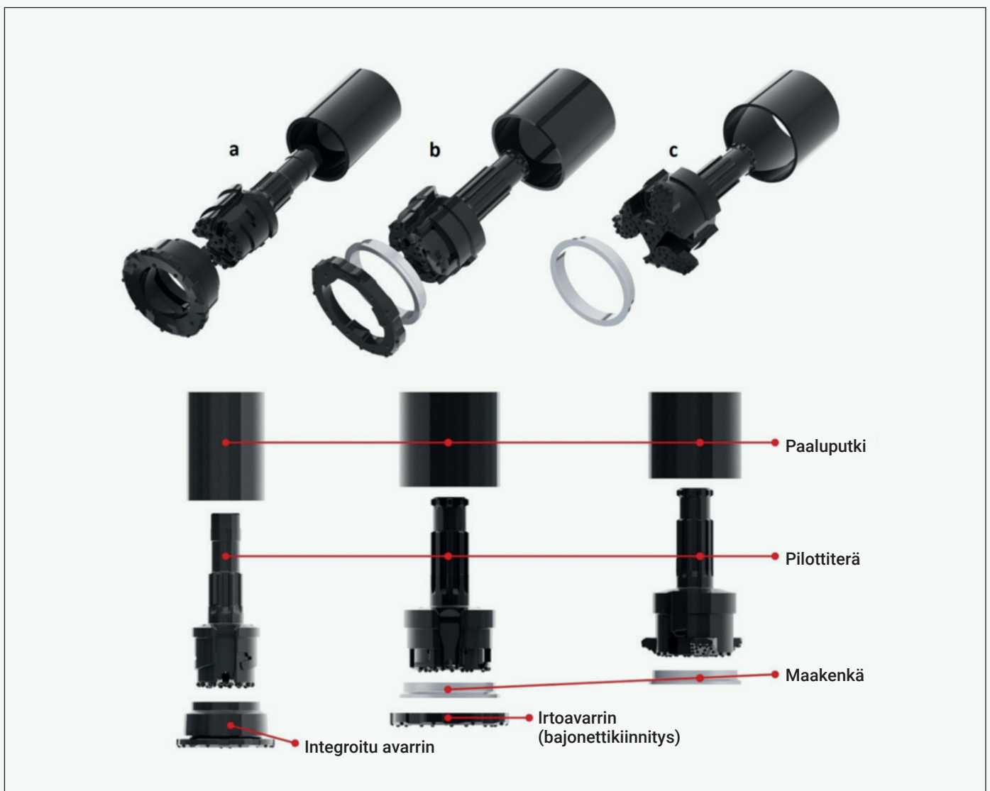
Kuva 13. RD-paaluseinän asennuksessa käytettävää teräkalustoa (Kuva: Robit Oyj)
