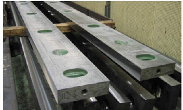
**Figura 2. Cuchillas de cizalla de Toolox<sup>®</sup> 44**
