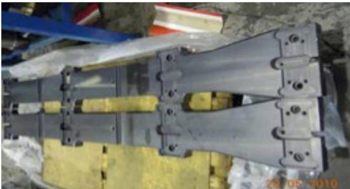
**Figura 1. Vigas de refuerzo de Toolox<sup>®</sup> 33**
