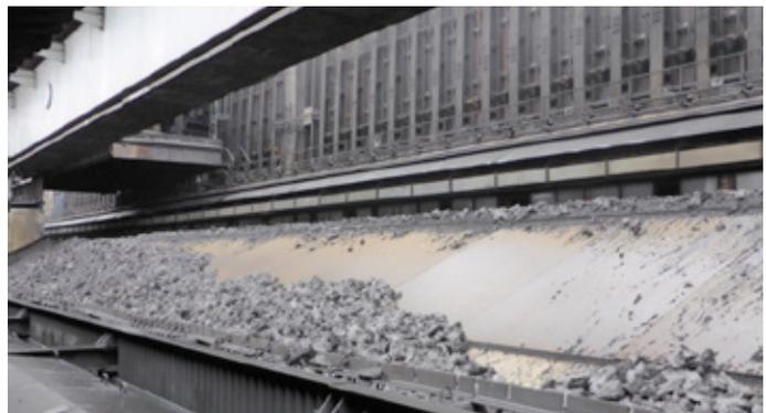
**Figura 4. Mesa de enfriado fabricado en Toolox® 33**
