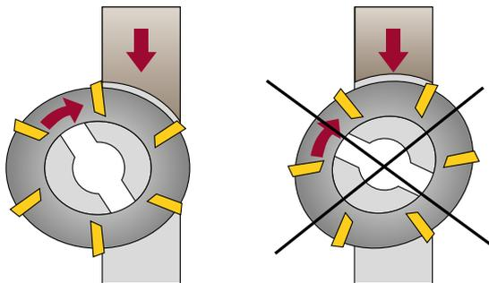
Si empieza a trabajar la pieza con fresado en contraposición (según figura), el grosor de la viruta a la salida es siempre cero, y esto ayudará a prolongar la vida útil de la herramienta.
