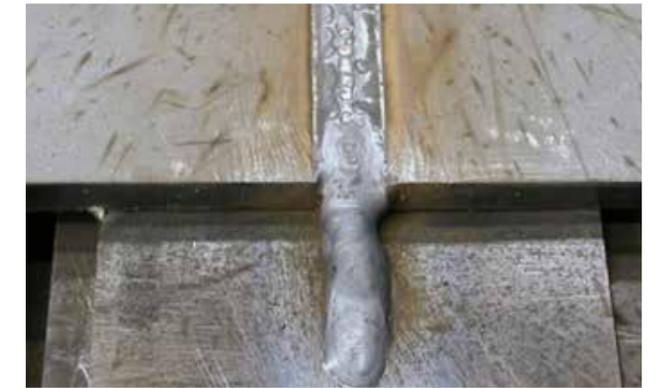
**FIGURA 25** Dirección adecuada de las marcas del disco de desbaste, orientadas de forma longitudinal a la tensión.
