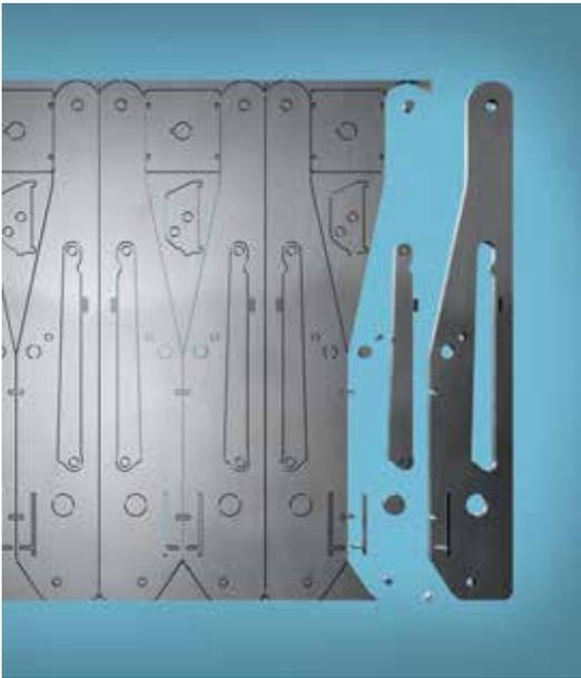
La calidad de la superficie influye, en gran medida, en la velocidad de corte y la calidad de los bordes de corte. SSAB Laser® siempre ofrece, para todas las modalidades de productos y formas de entrega, una superficie óptima para lograr un corte láser de alta calidad. Las líneas de corte pueden ser compartidas por varios cortes, y se pueden cortar con gran precisión orificios de pequeño diámetro y ranuras estrechas.
