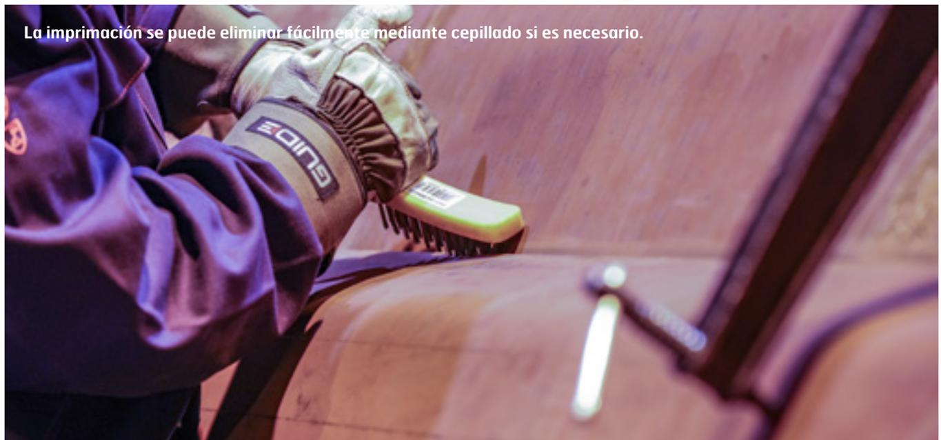
La imprimación se puede eliminar fácilmente mediante cepillado si es necesario.
