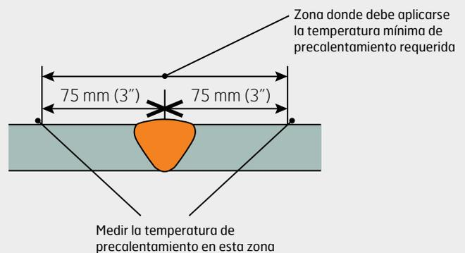
La temperatura entre soldaduras también se puede medir en el metal de soldadura o en el metal de base inmediatamente adyacente.
