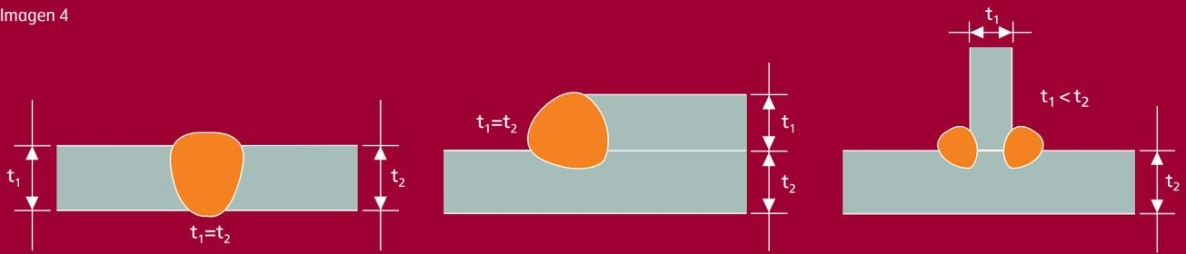
$t_1 = t_2$  El espesor de la chapa individual es  $t_1$  o  $t_2$ , siempre que se utilice el mismo tipo de acero.
