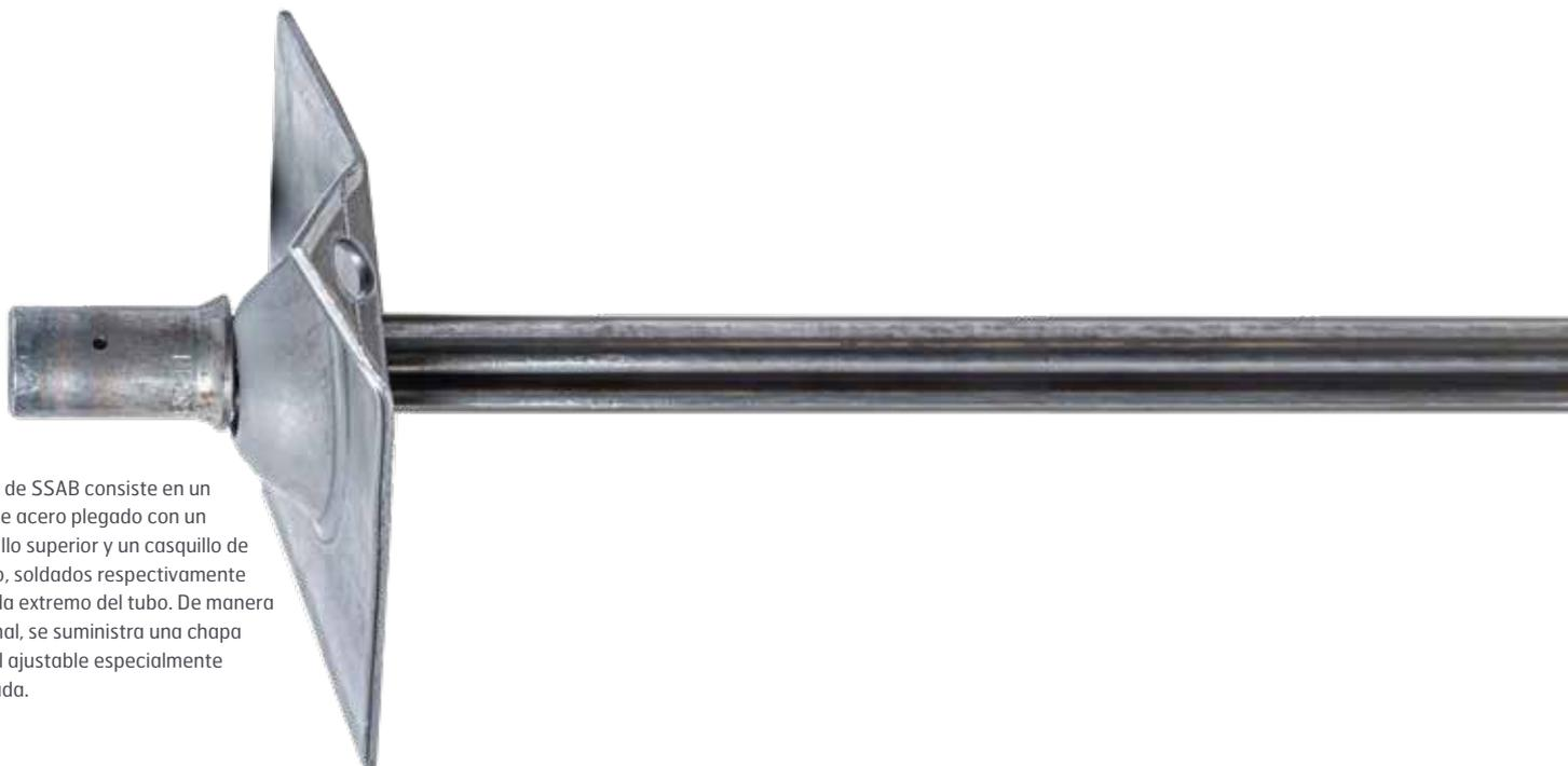
El ERB de SSAB consiste en un tubo de acero plegado con un casquillo superior y un casquillo de inflado, soldados respectivamente en cada extremo del tubo. De manera opcional, se suministra una chapa frontal ajustable especialmente diseñada.
