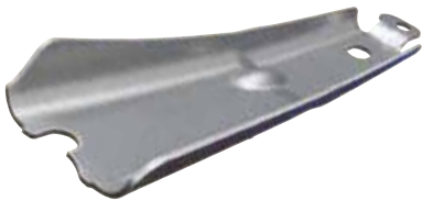
Figura 32. Refuerzo de pilar B.
