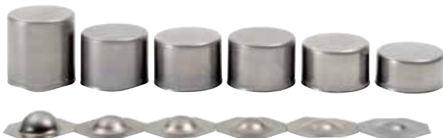
Figura 5. Profundidad de deformación máxima en el ensayo de estiramiento. Calidades de acero (de izquierda a derecha): CR5, Docol 600DP, Docol 800DP, Docol 1000DP, Docol 1200M y Docol 1400M.
