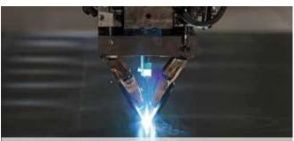
LASERSCHWEISSEN Max. Länge 20.000 mm. Max. Dicke 8 mm.
