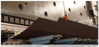
BIEGEN/STANZEN Max. Gewicht 4.000 t. Max. Arbeitslänge 21.000 mm.
