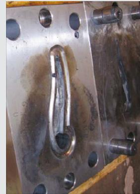
Messinggriffe werden in einem Gesenk aus Toolox® 44 mit einem Schlag bei 730 bis 750 °C gepresst.
