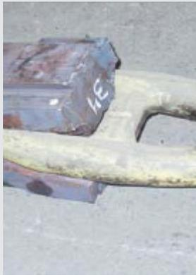
Toolox® 44 wird in einem Warm Schmiedegesenk für die Kettenproduktion verwendet. Der Kettenstahl wird vor dem Schmieden auf etwa 890 °C erhitzt. Das Gesenk setzt die Arbeit dann bei 400 bis 500 °C fort.
