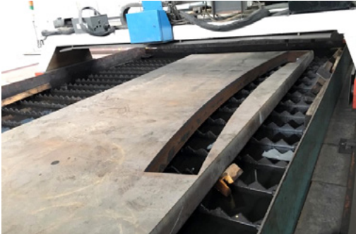
Abb. 1. Brennschneiden von Teilen aus Toolox®
