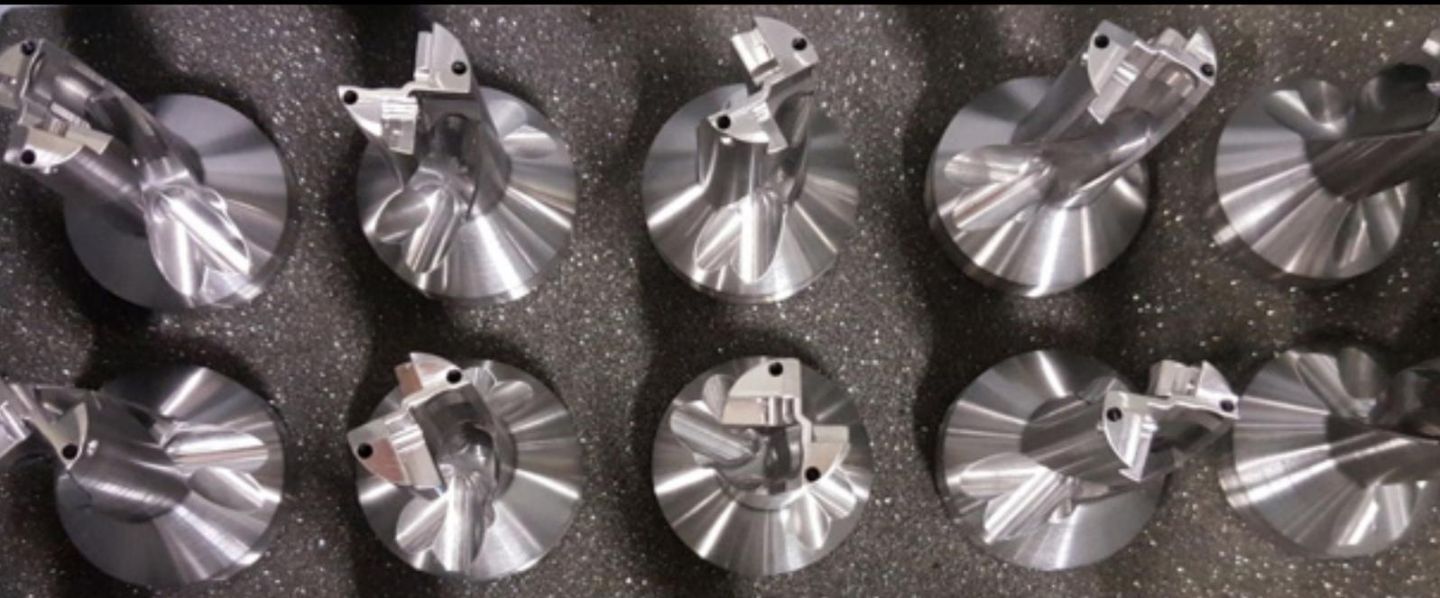
Toolox® ist ein neuer Stahl des schwedischen Spezialstahlherstellers SSAB. Er wird mit einer einzigartigen hohen mechanischen Festigkeit und Rissbeständigkeit geliefert. Daher ist er ideal für hochbeanspruchte Werkzeuge wie U-Bohrer und Hochgeschwindigkeitsfräsen. Die hohe mechanische Festigkeit von bis zu 45 HRC macht eine Wärmebehandlung überflüssig. So werden Vorlaufzeiten verkürzt und Qualitätsprobleme verringert.
