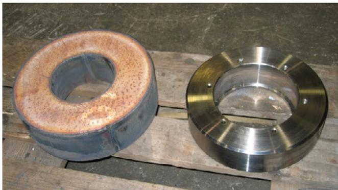
**Abb. 3. Lenkrad aus Toolox® 44**
