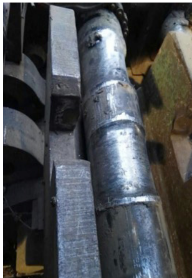
Hammerachsen aus 4340 Stahl
