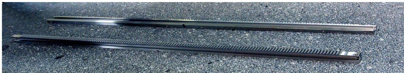
**Abb. 2.** Präzisionsbearbeitete Zahnstange aus Toolox® 33
