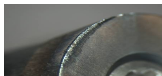
Im Kreisbogen in das Werkstück fahren (Roll-in-Entry)
