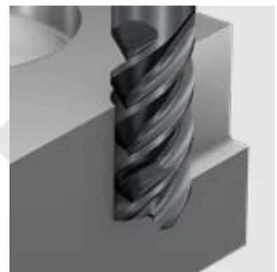
Eckfräsempfehlung ap (Verwendung der gesamten Schnittlänge)ae (radiale Schnitttiefe) max. 0,1 x D
