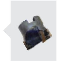
\*Hardox® HiAce hat sich beim Fräsen als sehr abrasiv erwiesen. Eine Wendeplatte mit hoher Härte (Bereich P10-P20) wird empfohlen. Die Wendeplatte sollte eine leichte Schneidgeometrie (L) aufweisen.
