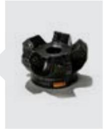
\*Hardox® HiAce hat sich beim Fräsen als sehr abrasiv erwiesen. Eine Wendep lattice mit hoher Härte (Bereich P10-P20) wird empfohlen. Die Wendep lattice sollte eine leichte Schneidgeometrie (L) aufweisen.
