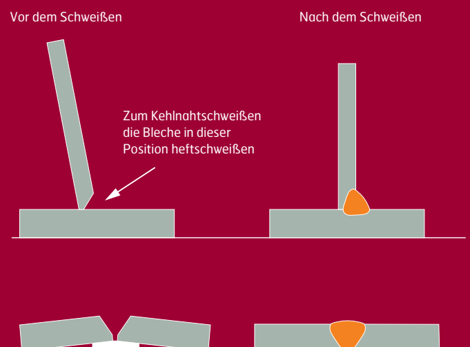
Abb. 11: Voreinstellung einer Kehlnaht und Einzel-Y-Naht.
