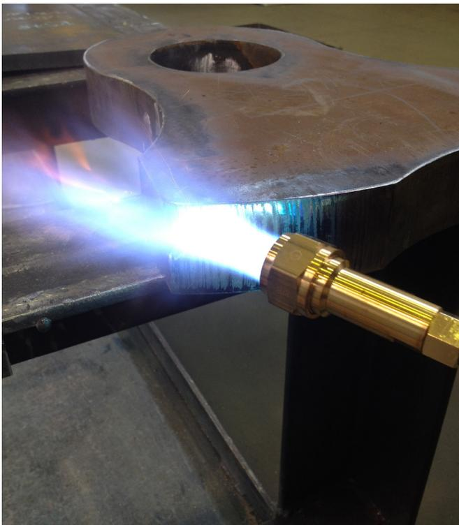
**Abb. 10:** Temperaturmessung während des Nachwärmens.
