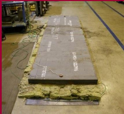
5. Legen Sie das Blech darauf und Thermoelemente darüber, die die Temperatur mit der Zeit aufzeichnen.
