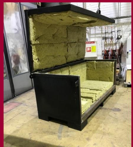
Dies kann sehr einfach für Vorwärmen, Nachwärmen und langsames Abkühlen verwendet werden.
