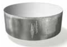
Adhäsiver Verschleiß/ Kaltaufschweißungen
