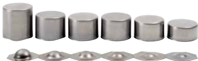
Abbildung 5. Maximalhöhe der Näpfe beim Tiefziehen und der Kuppelhöhe beim Streckziehen. Stahlgüten (v. l. n. r.): CR5, Docol 600DP, Docol 800DP, Docol 1000DP, Docol 1200M und Docol 1400M.
