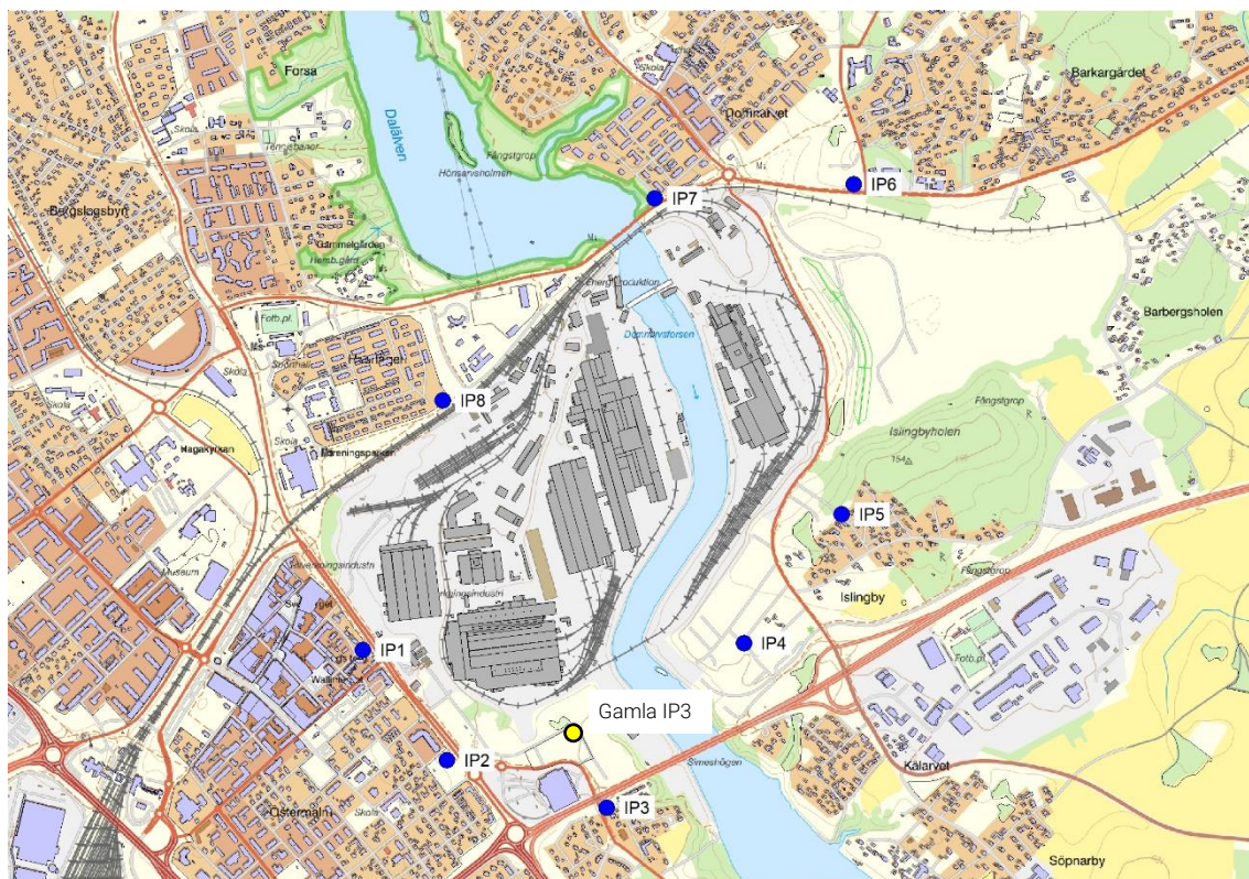
Figur 4-1. Immissionspunkter (IP1-IP8) för beräkning av bullerbidrag i omgivningen. Gul markering visar platsen för den punkt som tidigare representerade IP3.
