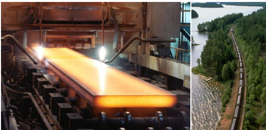
Figur 9: Stålsträng kapas till ämnen som efter kylning transporteras till Borlänge
