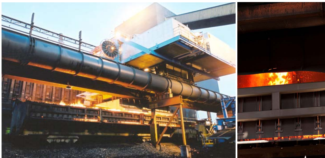
Figur 4: Tryckning av koks (koksverket)
