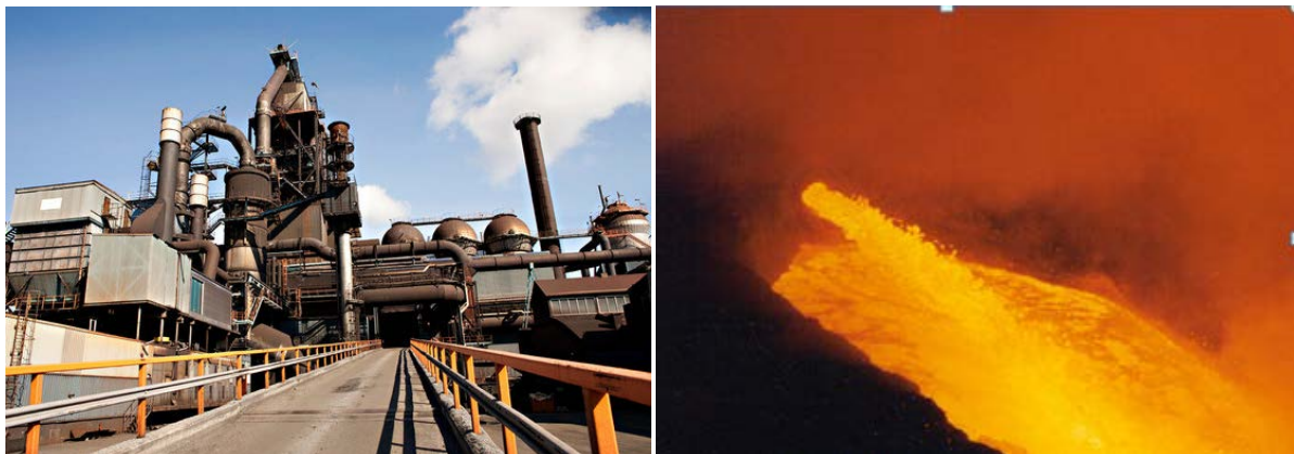
Figur 6: Masugnen och tappning av råjärn
