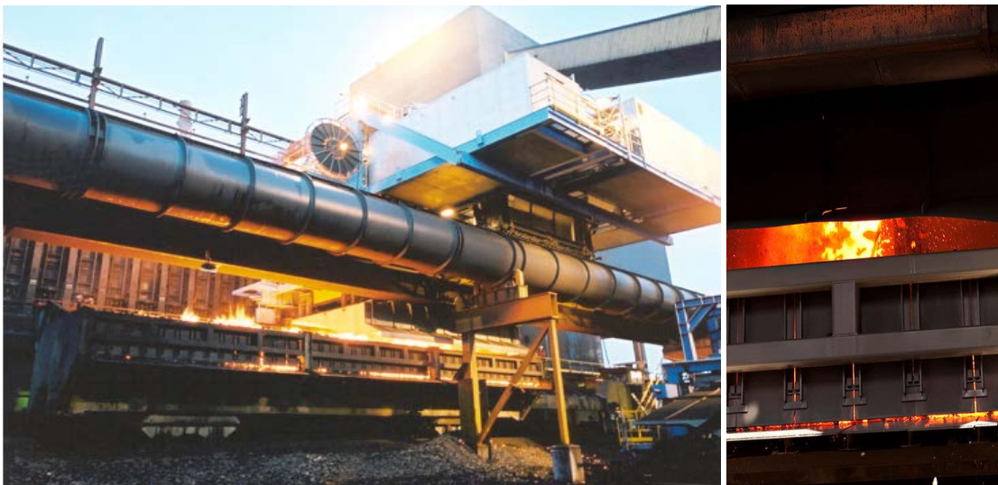
Figur 4: Tryckning av koks (koksverket)
