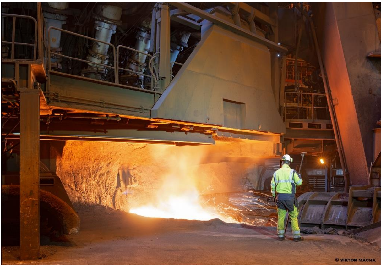
Figur 4. Tappning av råjärn från masugnen.
