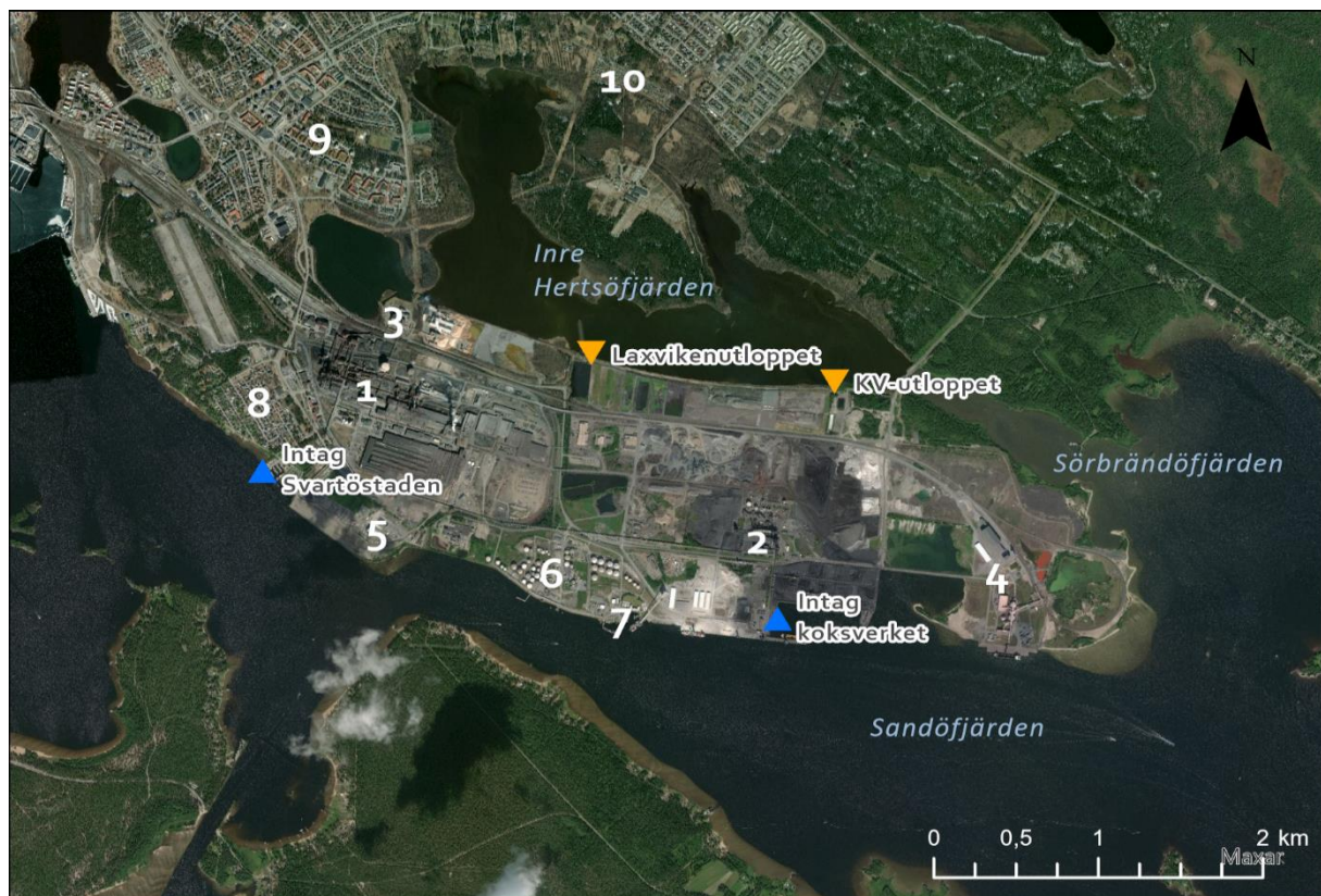
Figur 6. SSABs vattenintags- och utsläppspunkter samt omkringliggande verksamheter och bostadsområden. 1 – Masugns- och stålverksområdet, 2 – Koksverket, 3 – Lulekraft, 4 – LKAB, 5 – HYBRIT pilotanläggning, 6 – Oljehamnen, 7 – Luleå Hamn, 8 – Svartöstaden, 9 – Örnäset, 10 – Hertsön.
