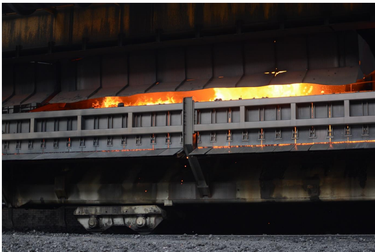
Figur 3. Tryckning av koks från batteriet.
