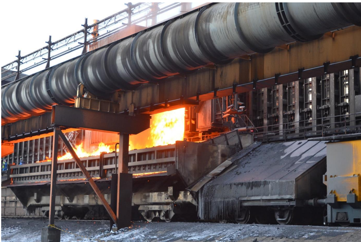
Figur 3. Tryckning av koks från batteriet.
