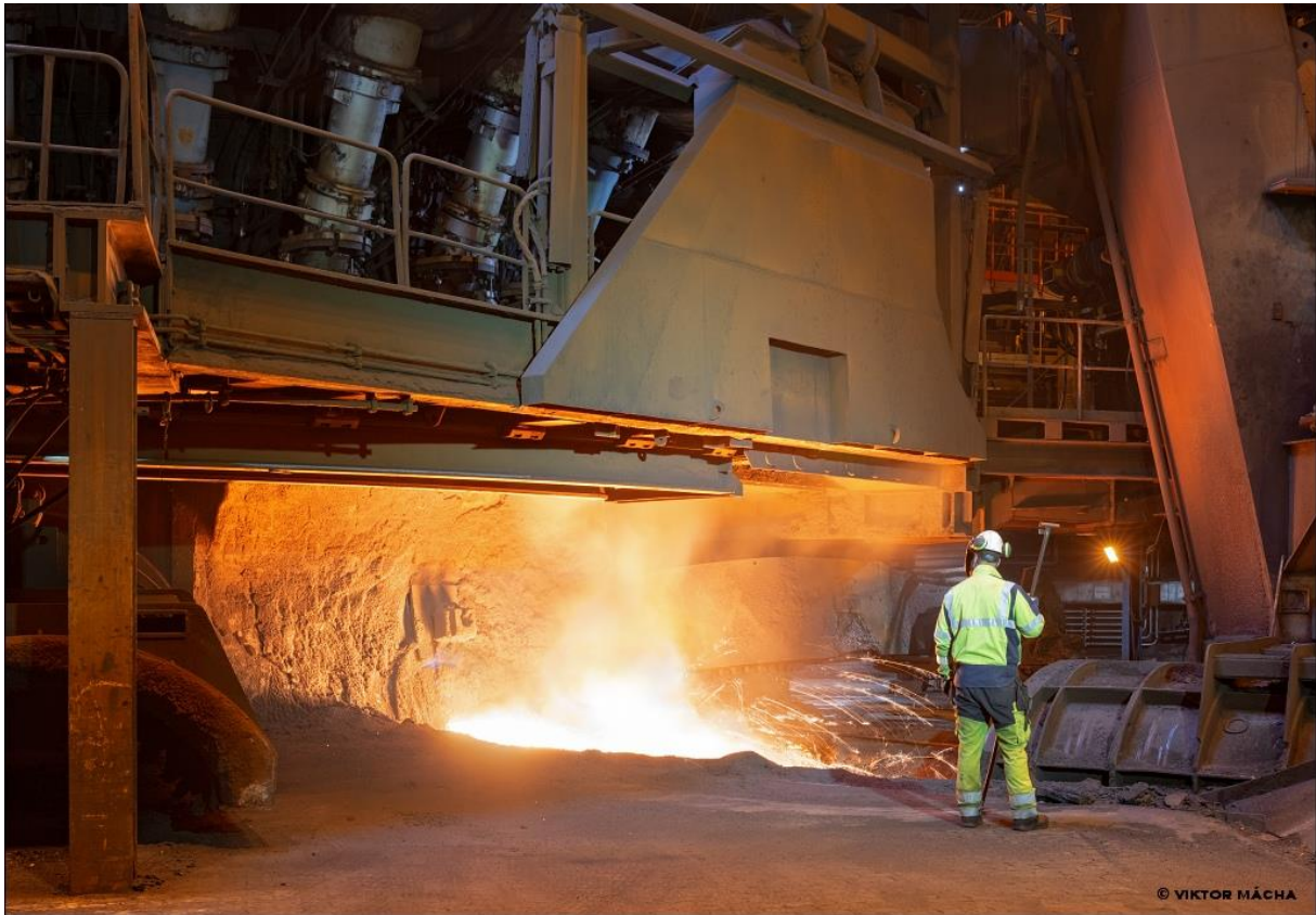
Figur 4. Tappning av råjärn från masugnen.
