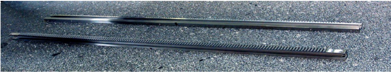
图 2. Toolox 33 精密机加工齿条。
