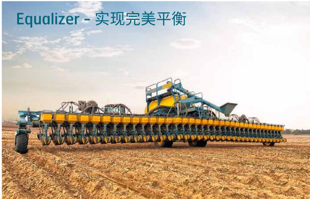
Equalizer 36行播种机采用 Strenx® 700 Tube 管材，以使其尽可能轻巧坚固。
