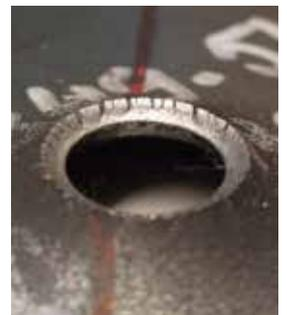
与 S700MC 钢不同, Strenx® 700MC Plus 的冲孔没有裂纹。
