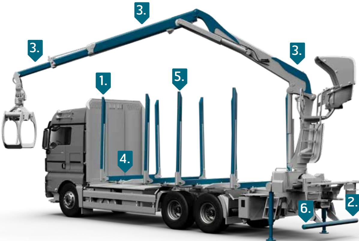
1. Strenx® Tube 700MLH, Strenx® Tube 900MH 高强度钢管
