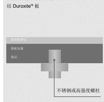
通过沉孔用螺栓紧固 Duroxite™ 板
