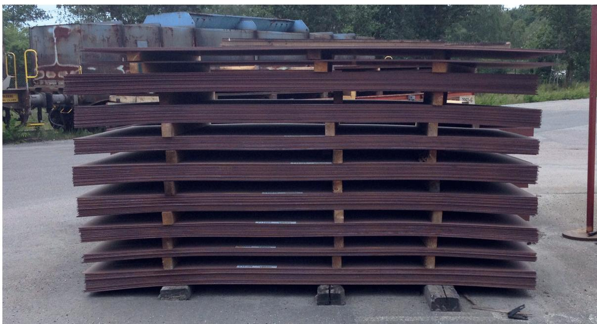
图 11. 钢板的正确堆叠方式。
